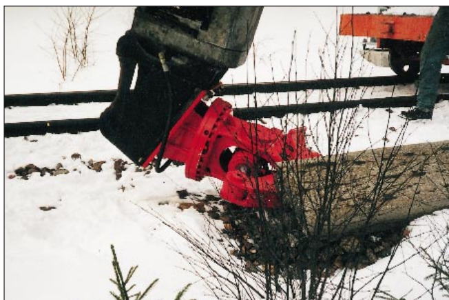
Ett av tillbehören är betongsaxen som klipper armerade pålar upp till 400 mm. Foto Gösta Malmquist.
