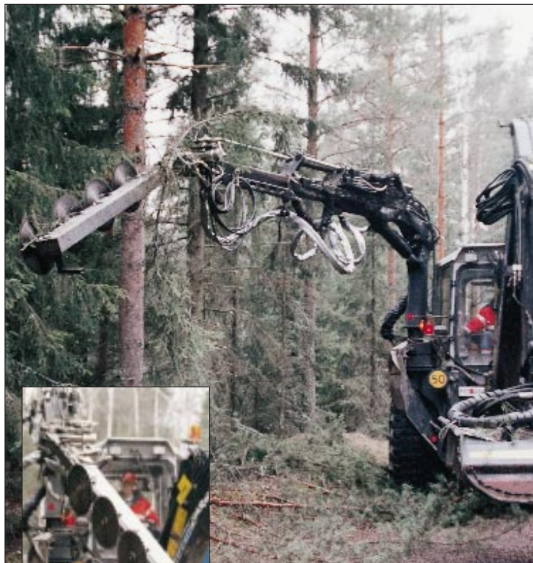
Den egenhändigt konstruerade röjsågen i aktion för väg- och linjeröjning. Foto Gösta Malmquist.
